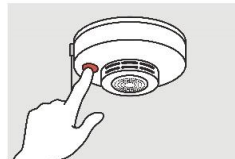
②火災の早期発見のために、住宅用火災警報器を定期的に点検し、10年を目安に交換する
